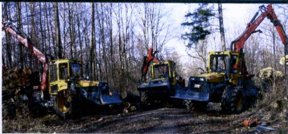
Oben: Drei der vier Welte W130 vom Forstbetrieb Hund sind mit Klemmbank und Ladekran von Loglift ausgerüstet. Links: Geschätzte acht Festmeter bekommt Michael Hund in Klemmbank und Greifer seines Welte W130M. Fotos: Jan Biernath
