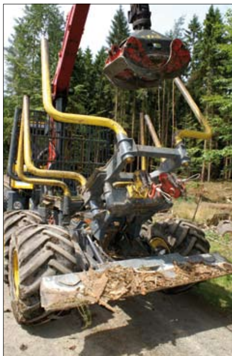
Abb. 2: Der Rungenkorb wird ausgehoben. Abb. 3: Durch Anheben des Rollenträgers kann auch bei aufgesetztem Rungenkorb Langholz beigeseilt werden.
