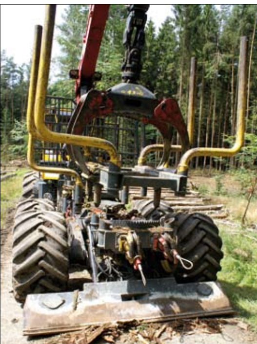
Abb. 2: Der Rungenkorb wird ausgehoben. Abb. 3: Durch Anheben des Rollenträgers kann auch bei aufgesetztem Rungenkorb Langholz beigeseilt werden.
