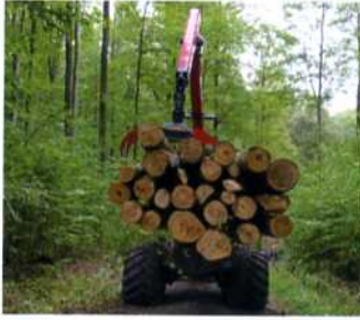
Für elf Tonnen Last ist der 140T gebaut, die Ingenieure haben aber ein wenig „Reserve“ eingeplant.
