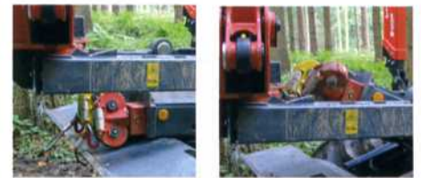
Der Rahmen läßt genug Platz für das Verstellen des Seileinzuges.
