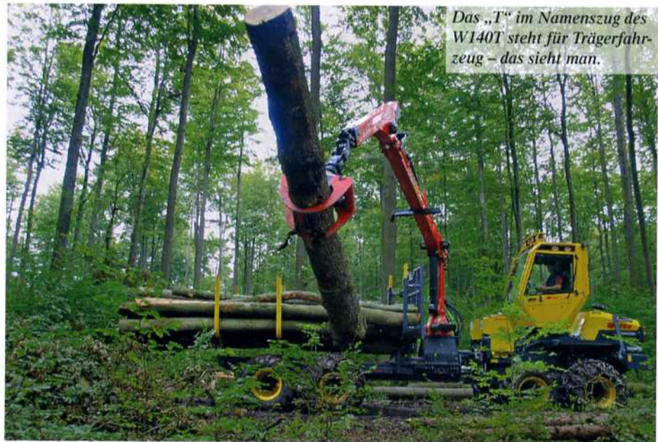
Für elf Tonnen Last ist der 140T gebaut, die Ingenieure haben aber ein wenig „Reserve“ eingeplant.
