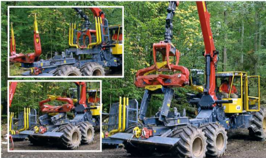
Mit dem Kran nimmt Harry Grewe den Rungenkorb ab (kleines Bild oben) und klappt dann die Klemmbank Richtung Kabine (großes Bild). Dann ist alles klar zum Langholzurücken (kleines Bild unten).
