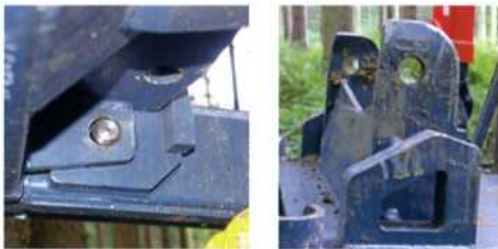
Die selben Zylinder halten die Klemmbank als Ränge aufrecht (links) oder arretieren sie in der Halterung zum Rücken von Langholz (rechts).
