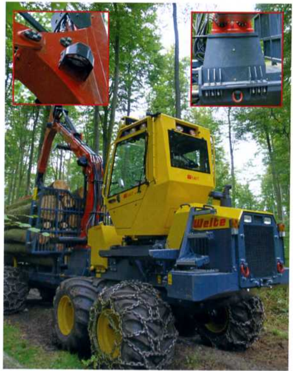
Der W140T kann um eine Doppeltrommelwinde erweitert werden. Ihr Platz ist dann unmittelbar unter dem Kran (kleines Bild rechts). Für gute Sicht sorgen vier serienmäßige Scheinwerfer am Epsilon-Kran (kleines Bild links). Fotos: Delbrügge
