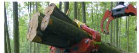
Die Zangenenden sind vorgespannt und üben zusätzliche Haltekräfte auf das Holz aus.
