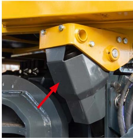
Erstmals bietet Welte einen Skidder mit passiver Kabinendämpfung an. An der Rückseite sind gut geschützt zwei Federbeine verbaut.
