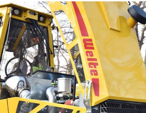
Waren die ersten W190 bei Markteinführung 2018 noch mit der Abgasnorm „TIER 4 final“ ausgerüstet, wird bei Eichenbergs neuem Modell die Abgasnorm TIER 5 eingehalten. Die erreicht der Volvo-Penta-Vierzylindermotor mit einem zusätzlichen Partikelfilter zur Abgasnachbehandlung.
