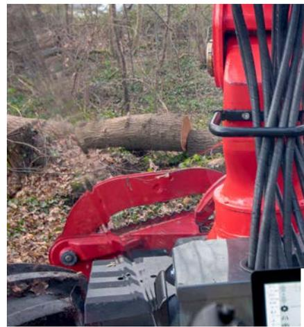
Die Panorama-Heckscheibe bietet freie Sicht auf den Arbeitsbereich. Der Touch-Bildschirm (rechts) kann in der Ansicht geteilt werden und beispielsweise die Frontkamera einblenden.
