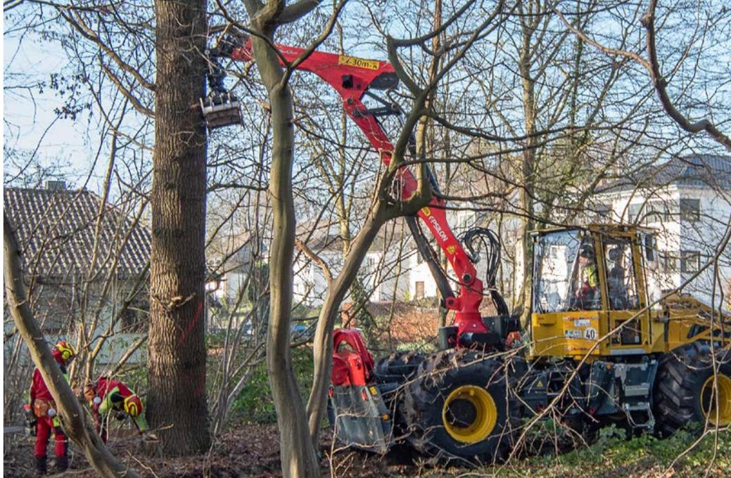
Bei der Verkehrssicherung ist die präzise Fallrichtung besonders wichtig: Wenn Tim Eichenberg nah genug an den Stamm herankommt, drückt er ihn mit dem Kran um. Das erspart den Männern am Boden die Keilarbeit, und sie können in sicherer Entfernung abwarten, bis der Baum am Boden liegt.
