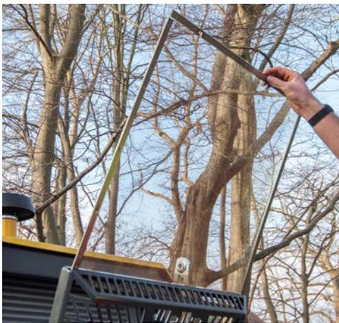
Damit Laub und Dreck erst gar nicht bis zum Kühler durchdringen, ist bei den Welte-Forstmaschinen ein Schutzgitter zwischen Kühler und Frontmaske verbaut. Frontmaske aufklappen, das Gitter zum Säubern rausziehen und wieder einsetzen dauert höchstens zwei Minuten. Fotos: Waid
