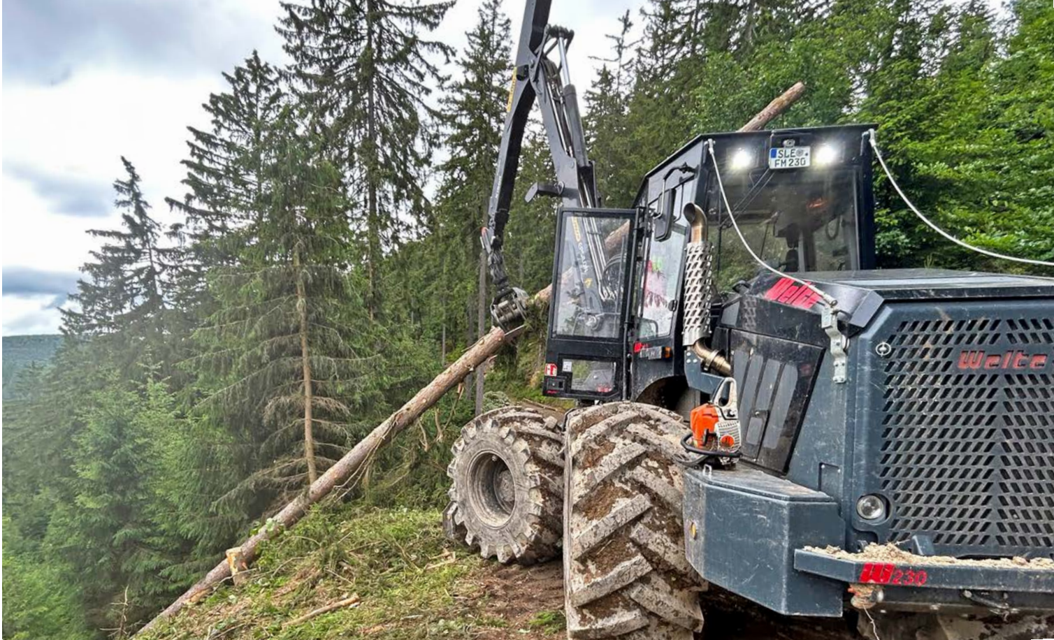
Zu steil für einen Harvester: Forstwirte fällen im Hang mit der Motorsäge, mit Winde und Kran wurden die Stämme auf den Weg gezogen. Linke Seite: Zwei Stöße 2,50-Meter-Abschnitte passen auf den Rückeanhänger. Fotos: Michael Müller (3), Waid
