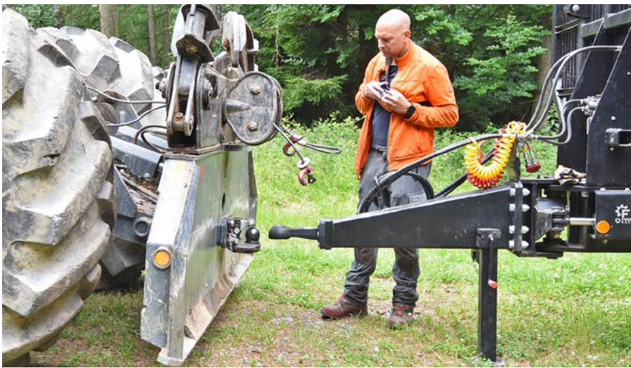
Oben: Mit der umgehängten Funksteuerung fährt Michael Müller die Maschine an den Anhänger heran. Auch die Lenkung und das Heckschild kann er damit steuern und so ganz einfach die Kupplung treffen. Die Deichselstütze wird anschließend am Gitter eingesteckt und gesichert (rechts, Pfeil).
