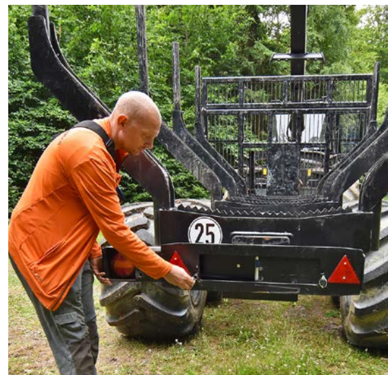
Praktisch gelöst: Ein Handgriff links, ein Handgriff rechts, dann sind Kennzeichen und Rückleuchten für die Straßenfahrt sichtbar beziehungsweise in Position gebracht.
