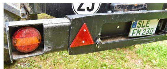
Praktisch gelöst: Ein Handgriff links, ein Handgriff rechts, dann sind Kennzeichen und Rückleuchten für die Straßenfahrt sichtbar beziehungsweise in Position gebracht.
