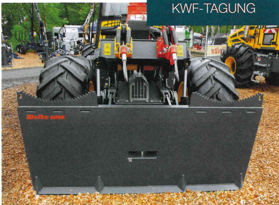
Mit dem W100 führt Welte auch ein neues Heckschild mit höhenverstellbaren Seileinlauf ein
