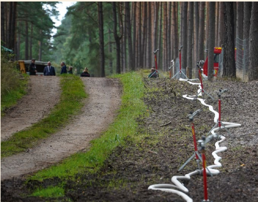
Demonstration von Kreisregnern für den Einsatz in munitionsbelasteten Gebieten. Auf dem Thementag 2024 war zu sehen, wie die eigentlich in der Landwirtschaft eingesetzte Technik zur Waldbrandbekämpfung und Nachsorge genutzt werden kann.
