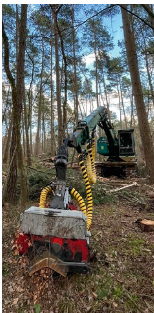
Geschützte Forsttechnik kam bei einem forstlichen Eingriff auf über 200 Hektar kampfmittelbelasteten Waldgebieten zum Einsatz.
