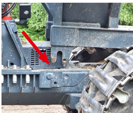
... wird mit dem Ladekran in die Aufnahmen (rundes Bild) gesetzt, formschlüssig eingerastet (unten, Pfeil) und dann hydraulisch verriegelt. Ein „Bolzen stecken und ziehen“ ist nicht nötig.
