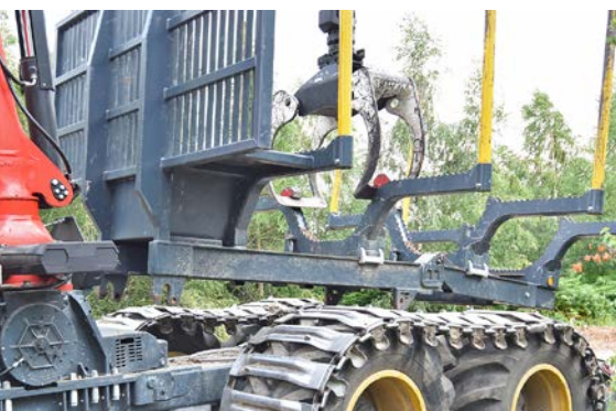
... wird mit dem Ladekran in die Aufnahmen (rundes Bild) gesetzt, formschlüssig eingerastet (unten, Pfeil) und dann hydraulisch verriegelt. Ein „Bolzen stecken und ziehen“ ist nicht nötig.
