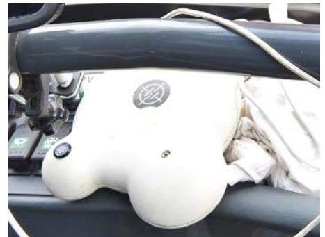
Den geplanten, schnurgeraden Gassenverlauf sieht der Fahrer auf einem Display in der Kabine. Der Empfänger für das Signal zur Positionsbestimmung ist ebenfalls in der Kabine platziert (Foto unten).
