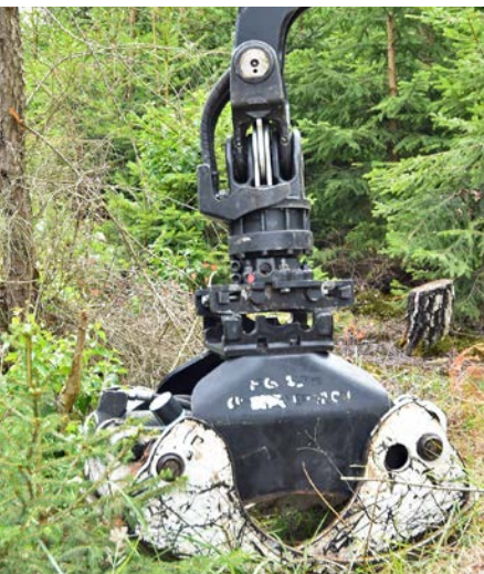
Oben und links: Das geht mit ein paar Handgriffen: Fällgreifer lösen, Kran mit Schnellwechselplatte zum Holzgreifer schwenken, wieder zwei Schrauben festziehen, Hydraulikschläuche verbinden, fertig.
