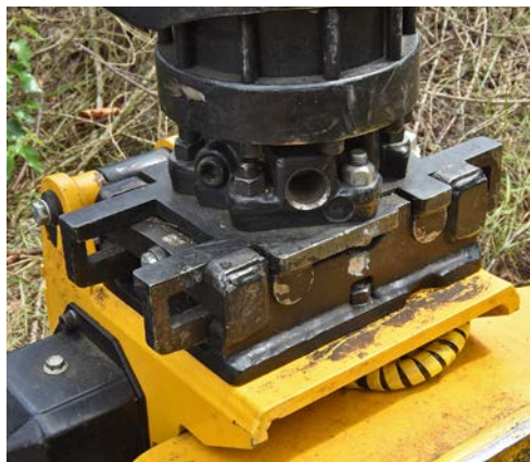
Oben und links: Das geht mit ein paar Handgriffen: Fällgreifer lösen, Kran mit Schnellwechselplatte zum Holzgreifer schwenken, wieder zwei Schrauben festziehen, Hydraulikschläuche verbinden, fertig.
