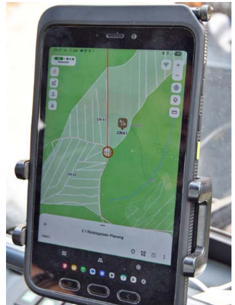
Den geplanten, schnurgeraden Gassenverlauf sieht der Fahrer auf einem Display in der Kabine. Der Empfänger für das Signal zur Positionsbestimmung ist ebenfalls in der Kabine platziert (Foto unten).
